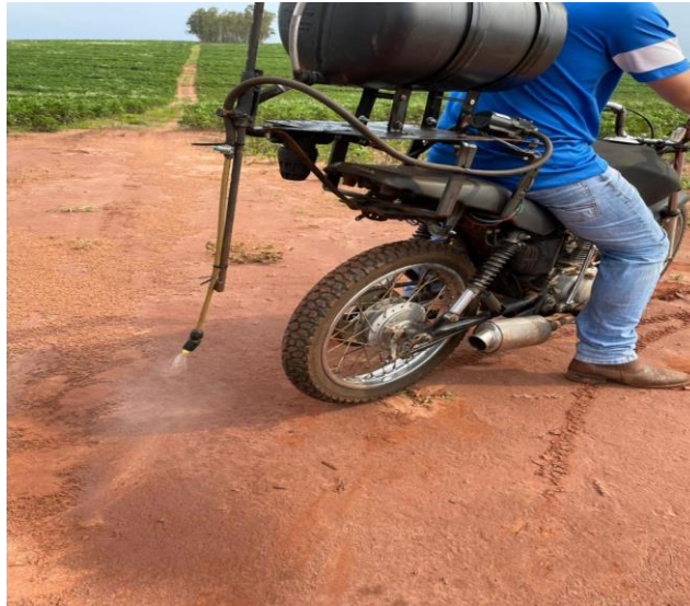
Foto 6 – Teste prático de motocicleta pulverizadora (2)
