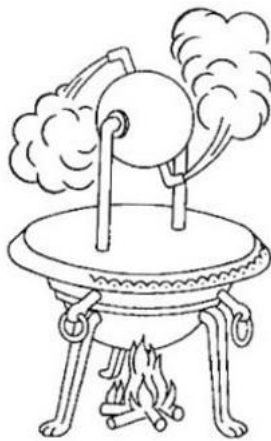
Figura 1 - Aeolipile, dispositivo térmico de Hero de Alexandria, 50 d.C. [8]
