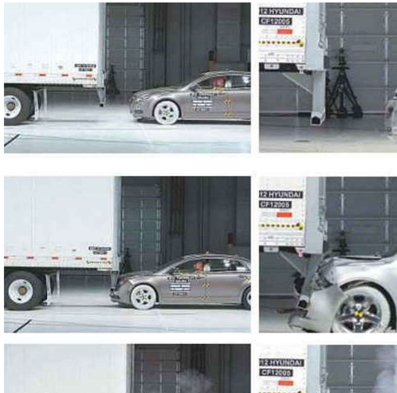
Figura 10 – A esquerda um para-choque mal dimensionado e a direita um adequado e dimensionado conforme a resolução 593/2016.
