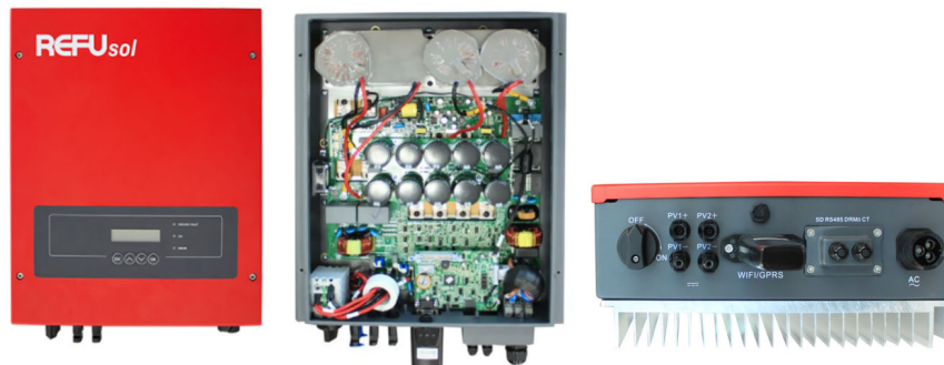
Figura 6 – Vista frontal com e sem tampa e vista inferior do inversor
