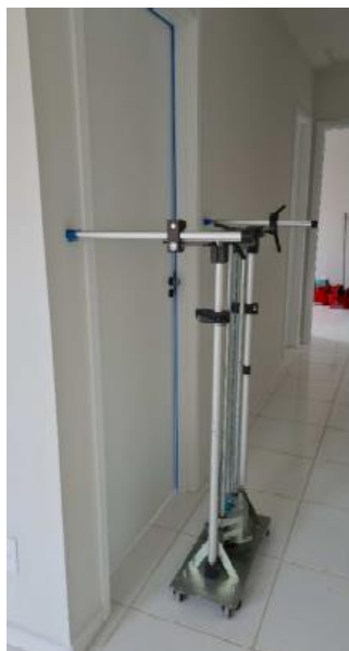
Imagem 9 – Equipamento com o contrapeso de 150 KN – construtora 2.
