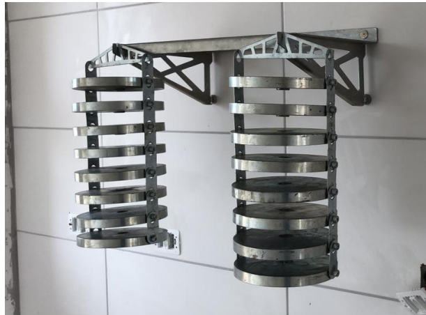
Imagem 1 – Ensaio de Carga Suspensa – Construtora 1.
