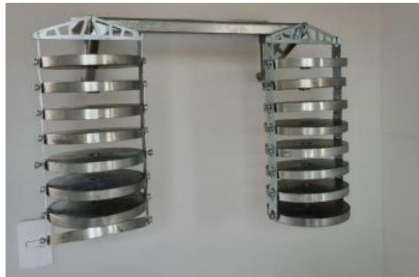
Imagem 2 - Ensaio de Carga Suspensa – Construtora 2.
