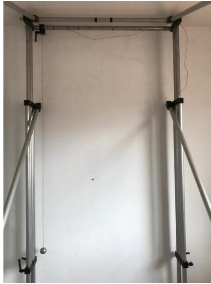
Imagem 6 – Instalação do equipamento para ensaio de impacto de corpo duro.
