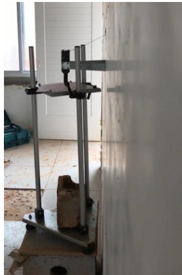
Imagem 5 – Instalação do equipamento para registro gráfico do ensaio.
