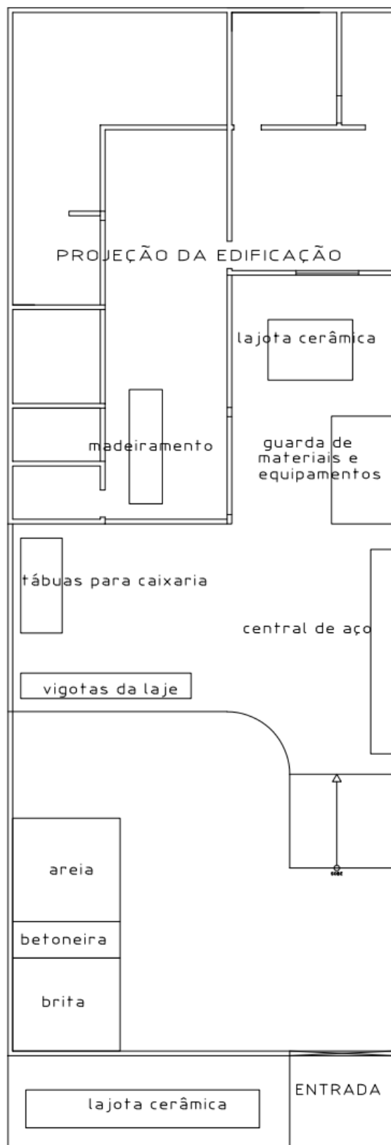
Imagem 14 - Disposição do canteiro de obras atualmente
