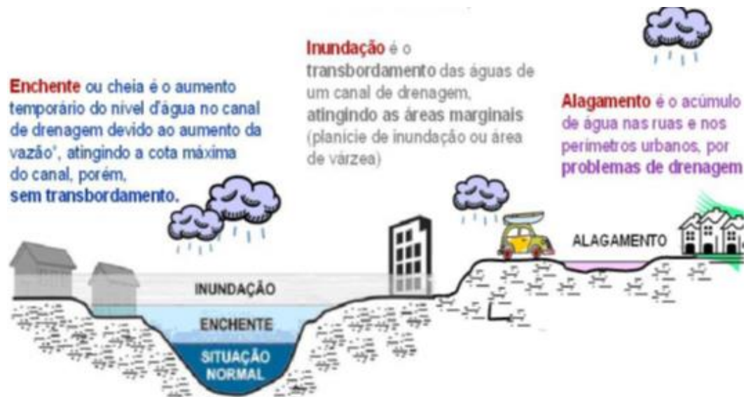
Figura 4- Perfil esquemático de enchente, inundação e alagamento.
