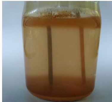
Imagem 7: sistema montado entre Cobre e Ferro
