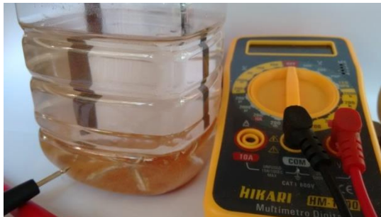
Imagem 13: sistema montado entre Grafite e Ferro
