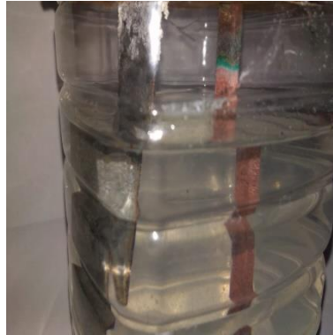
Imagem 5: sistema montado entre Cobre e Zinco
