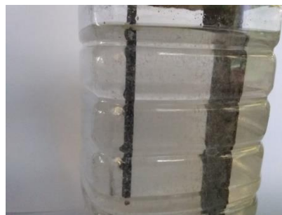
Imagem 11: sistema montado entre Grafite e Zinco
