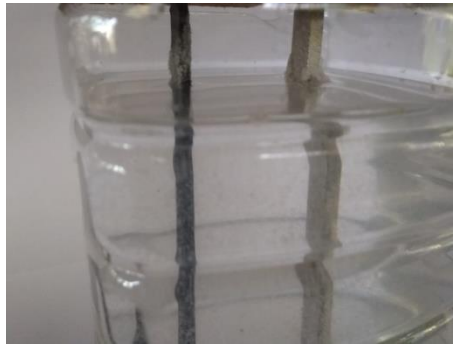
Imagem 9: sistema montado entre Grafite e Alumínio
