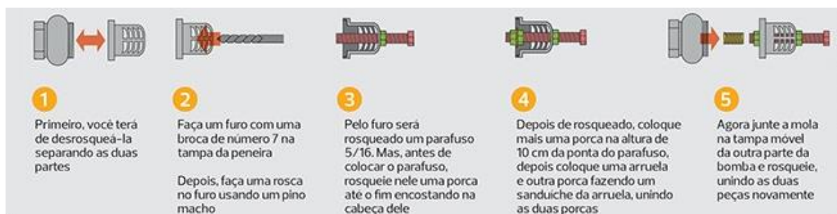
Figura 6 - Adaptação da válvula de sucção.
