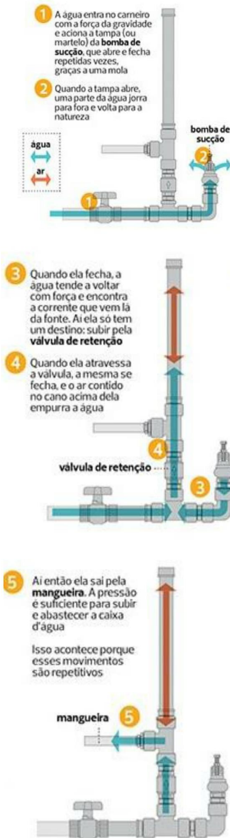
Figura 2 - Funcionamento do CH alternativo.
