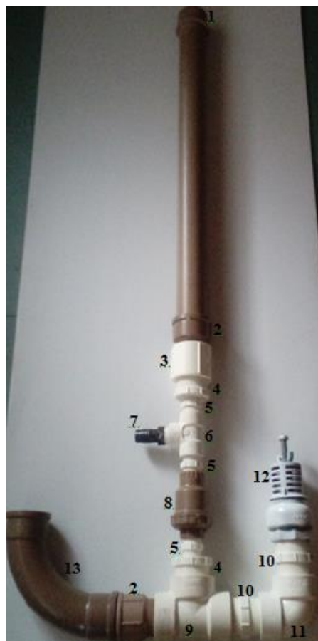
Figura 9 - Carneiro Hidráulico "C"
