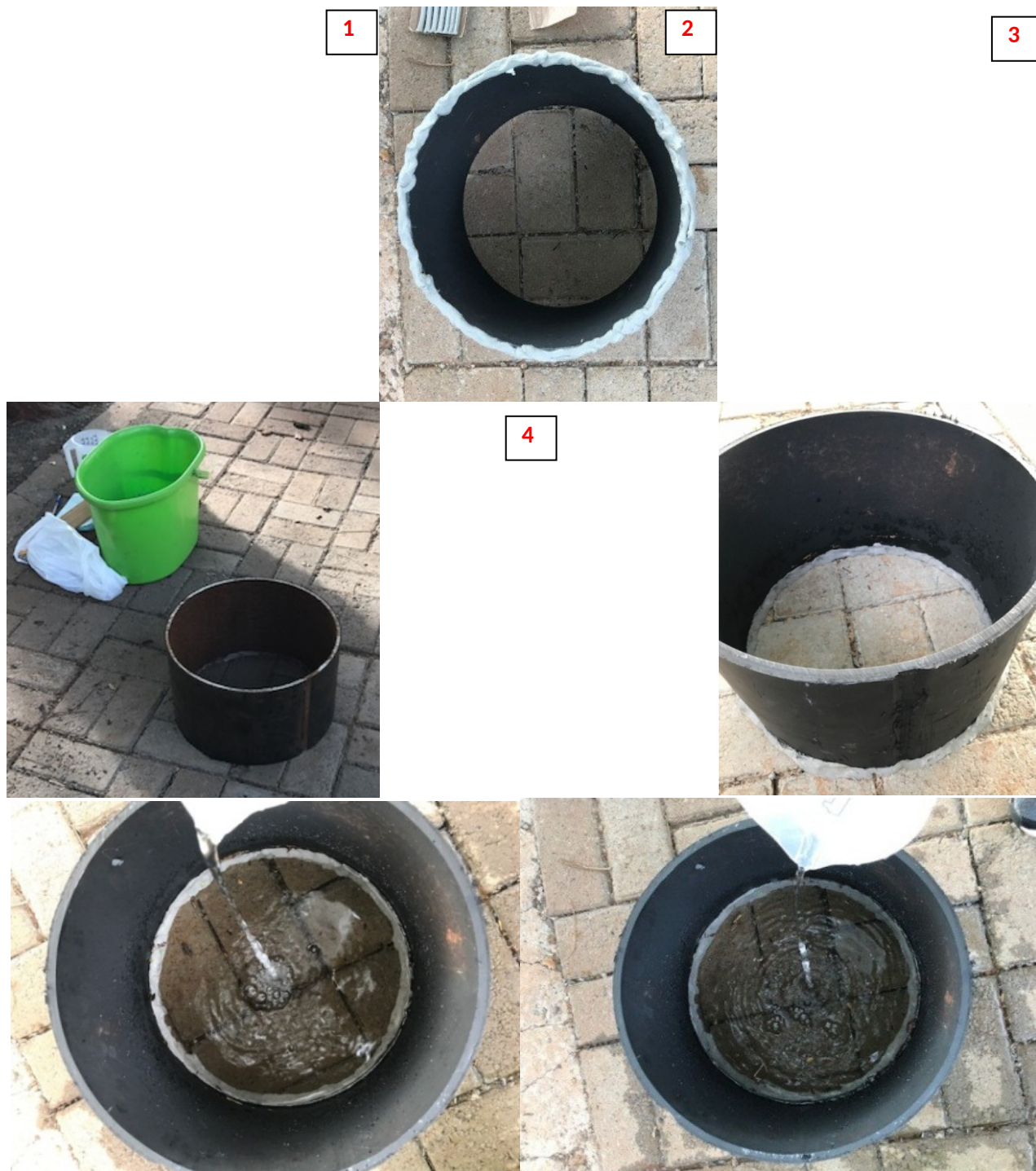
Figura 02: Dispositivo de Infiltração
