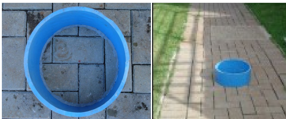
Figura 02: Dispositivo de Infiltração Fonte: JABUR (2013)
