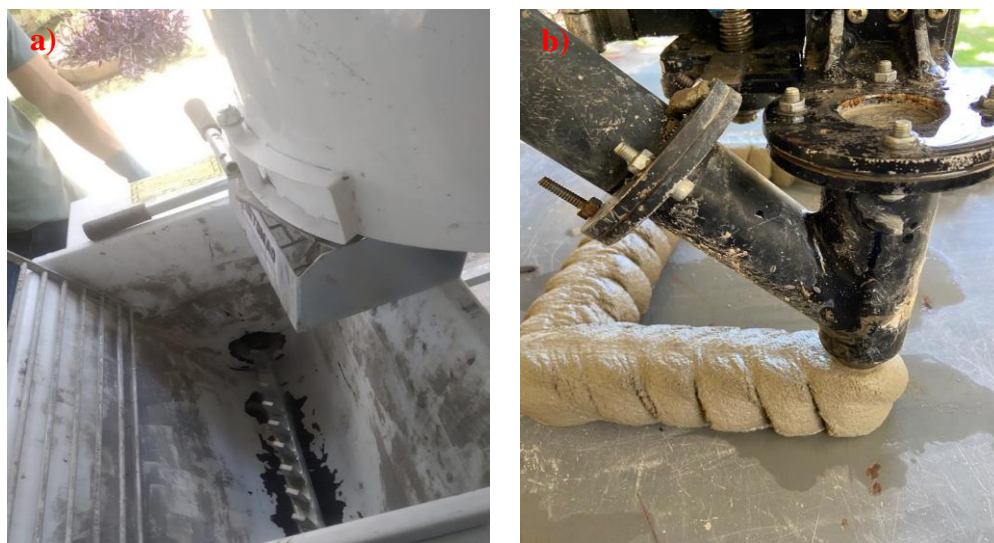
Figura 23 – Sistema de bombeamento. (a) Compartimento da bomba de injeção para armazenamento da argamassa, (b) bico da extrusora.
