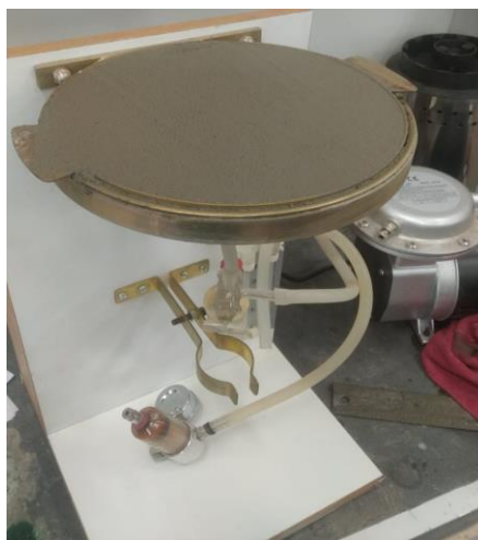
Figura 27 – Funil de Blücher utilizado para ensaio da absorção de água.
