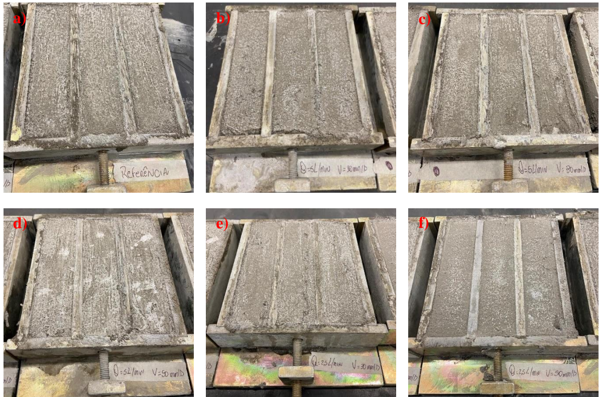
Figura 31 – CP's para ensaios mecânicos das amostras de argamassa. (a) AR – 1; (b) AE1 – 10; (c) AE1 – 30; (d) AE1 – 50; (e) AE2 – 30; (f) AE2 – 50.
