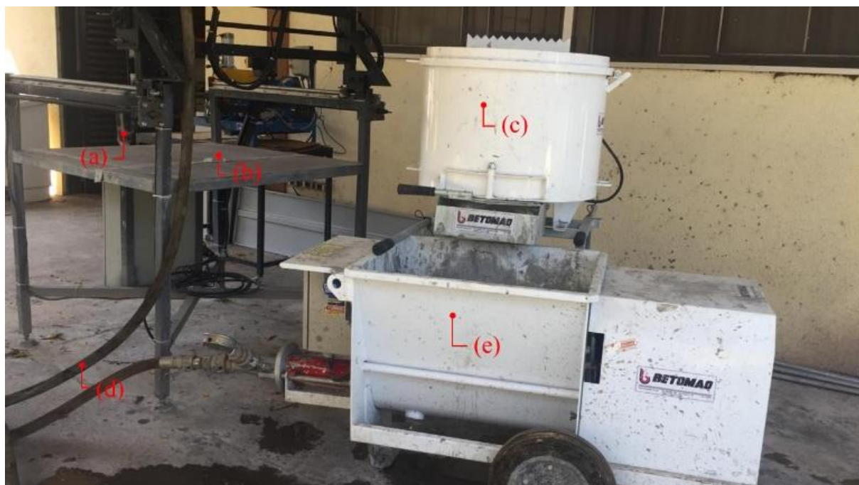
Figura 33 – Conjunto de equipamentos utilizados na montagem do protótipo de impressora 3D em escala de bancada: (a) Bico extrusor; (b) Protótipo de impressora 3D em escala de bancada; (c) Misturador de argamassa; (d) Mangueira de transporte da argamassa; (e) Bomba de injeção de argamassa.
