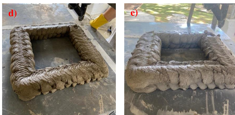
Figura 36 – Impressões dos objetos para as amostras de argamassas. (a) AE1 – 10; (b) AE1 – 30; (c) AE1 – 50; (d) AE2 – 30; (e) AE2 – 50.
