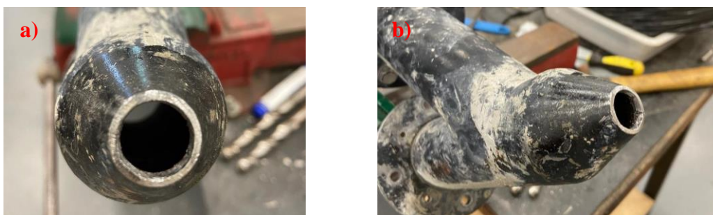
Figura 16 – Bocal do protótipo de impressora 3D em escala de bancada com 20 mm de diâmetro: (a) Vista Frontal; (b) Vista Lateral.
