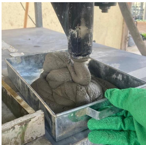
Figura 26 – Coleta das amostras de argamassas em recipiente metálico para a realização dos ensaios de índice de consistência.
