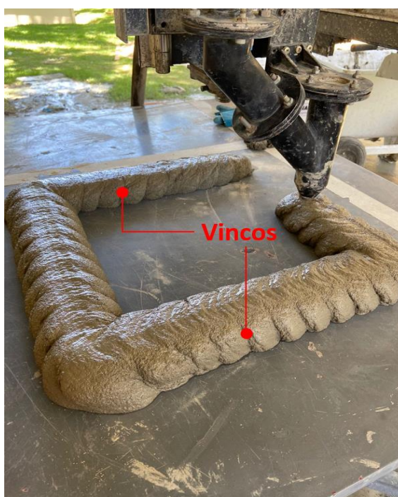
Figura 37 – Impressão da primeira camada da argamassa AE1 – 50, com a bomba B40 Betomaq. Fonte: (Autor, 2022).
