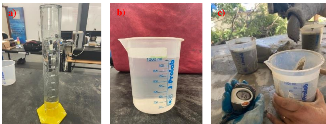
Figura 17 – Calibração do béquer para ensaio de vazão volumétrica: (a) Proveta graduada 1000 ml com água destilada; (b) Béquer com a água destilada já calibrado; (c) Ensaio da vazão volumétrica com béquer calibrado em 1000 ml.
