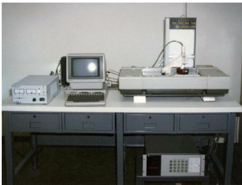
Figura 2 – Primeira impressora para fabricação de objetos tridimensionais desenvolvida por Charles Chuck Hull.
