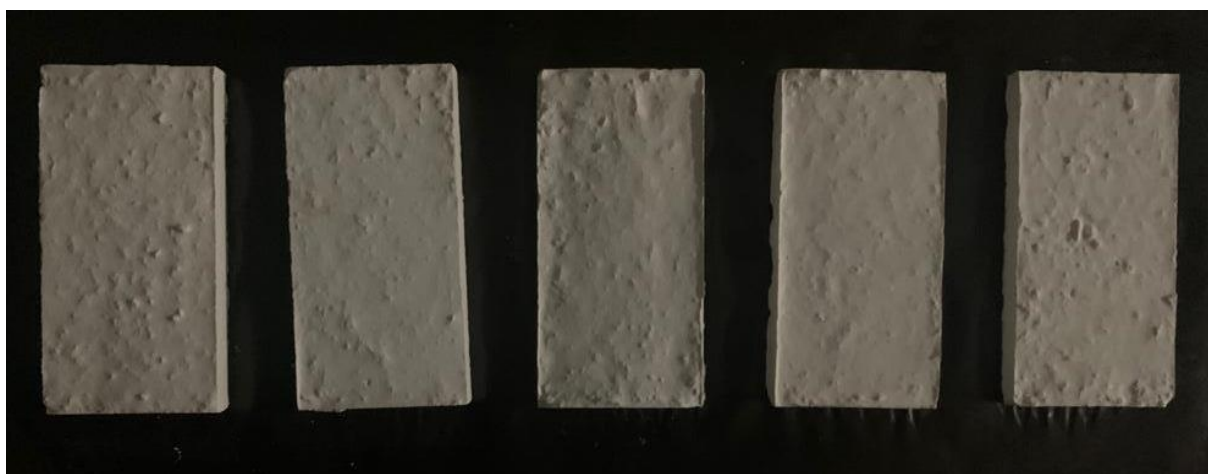
Figura 14 – Corpos de prova analisados após ensaio para determinação de resistência ao choque térmico, utilizando o teor de substituição 14. Fonte: Autora (2022).
