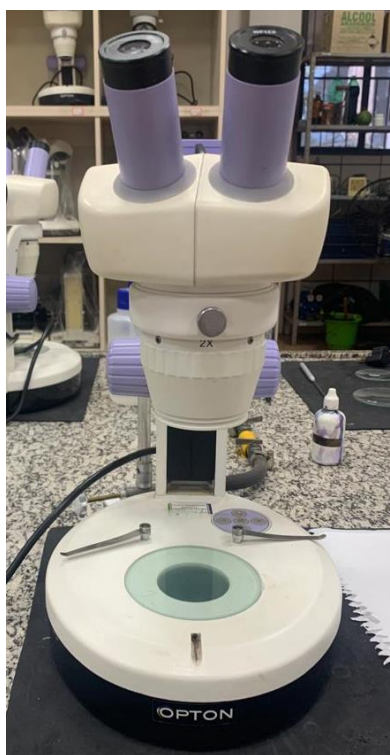
Figura 6 – Lupa Estereoscópica Binocular, Modelo TIM-30, Opton Microscópios utilizado para separar 300 grãos representativos da amostra. Fonte: Autora, 2022.
