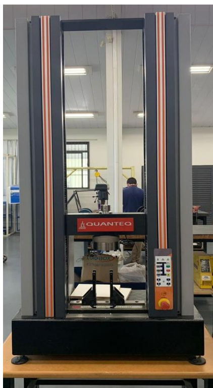
Figura 8 – Equipamento de ensaio de flexão, Modelo DL 20000 EMIC, Quanteq utilizado para verificação da resistência de cada corpo de prova. Laboratório de Mecânica UniCesumar.
