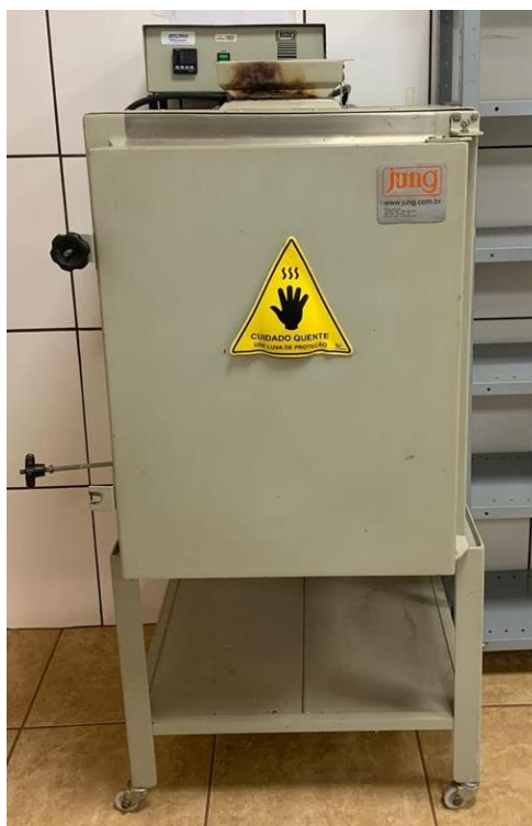
Figura 9 – Forno, Modelo 10010, Jung, 2007, utilizado para verificação da expansão dos revestimentos cimentícios. Laboratório de Fitopatologia UniCesumar. Fonte: Autora, 2022.
