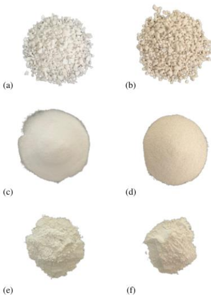
Figura 4 – Resíduos triturados através de golpes de marreta para garantir a granulometria desejada. Granilha (a), agregado reciclado granilha (b), dolomita (c), agregado reciclado dolomita (d), cimento branco (e) e agregado reciclado cimento (f). Fonte: Autora (2022).
