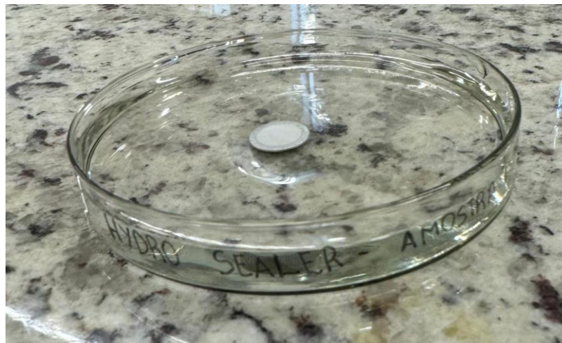
Foto 4 – Cimento sob 50ml de água destilada para o teste de solubilidade.
