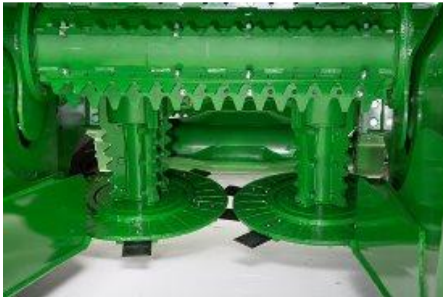
Figura 6 - Caixa corte de base
