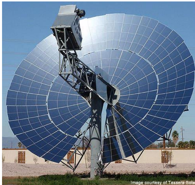
Figura 6 - Concentrador Solar Parabólico
