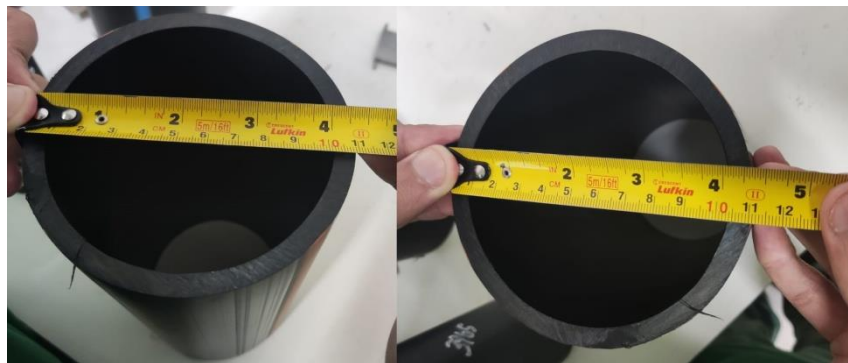
Figura 19 – Medição da ovalização por trena da amostra 3
