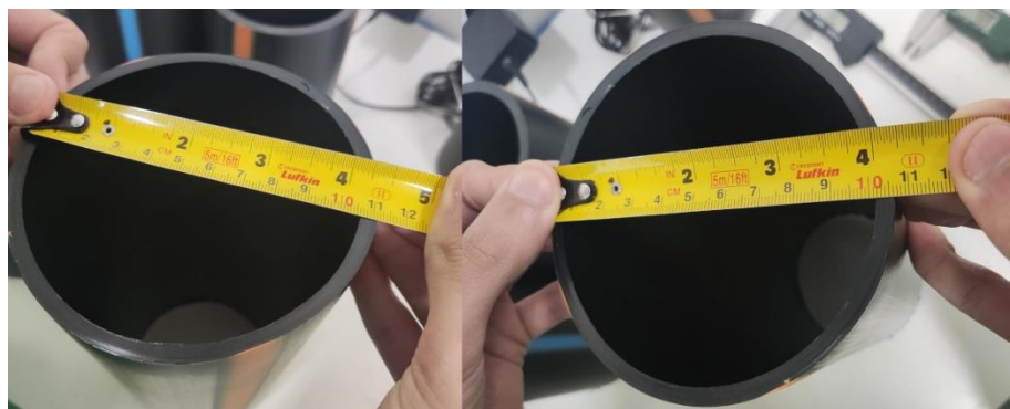
Figura 29 – Medição da ovalização por trena da amostra 5
