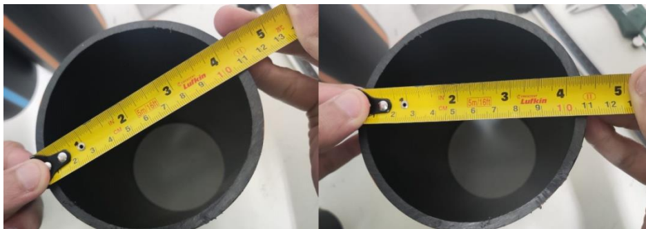
Figura 24 – Medição da ovalização por trena da amostra 4
