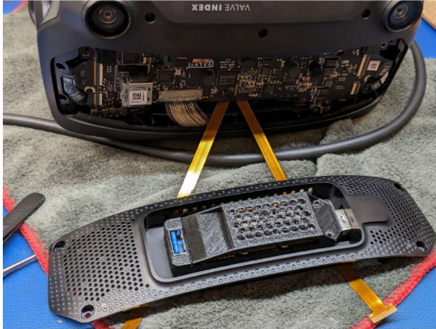
Figura 5 – Modelo Phys-Index-EyetrackVR-HW montado na placa frontal do dispositivo de RV
