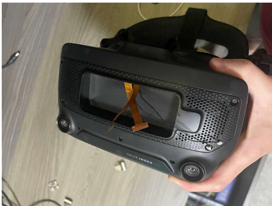
Figura 15 – Placa frontal encaixada com passagem dos fios feita
