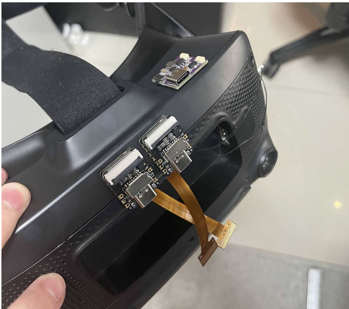
Figura 16 – Fixação das placas controladoras no dispositivo
