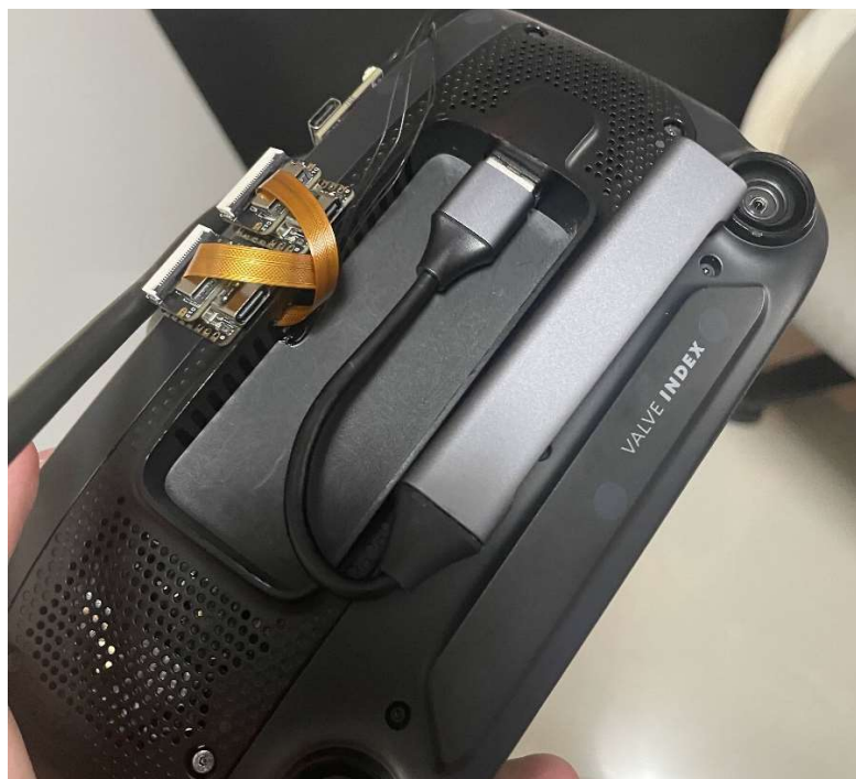
Figura 18 – USB hub anexado na carcaça do dispositivo
