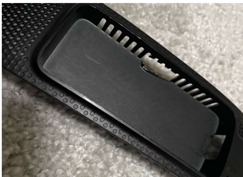
Figura 12 – Buraco feito na placa frontal do dispositivo
