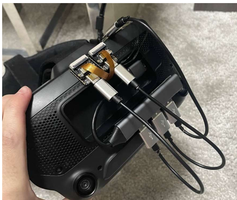
Figura 19 – Conexão feita entre as placas controladoras e o USB hub
