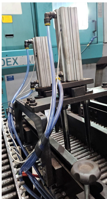
Figura 24 - Atuador pneumático e sensor magnético instalados.
