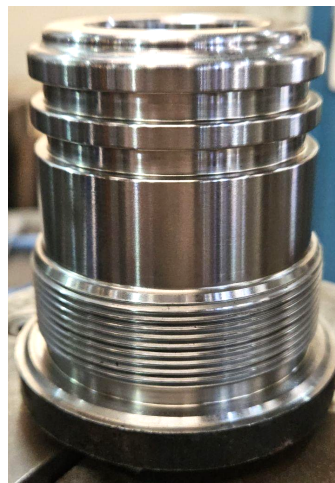
Figura 6 - Primeira etapa usinagem Guia Roscado
