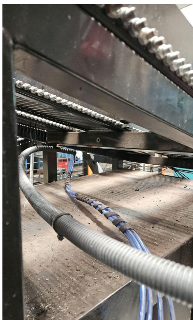
Figura 23 - Tubo poliuretano e cabos do sensor magnético.
