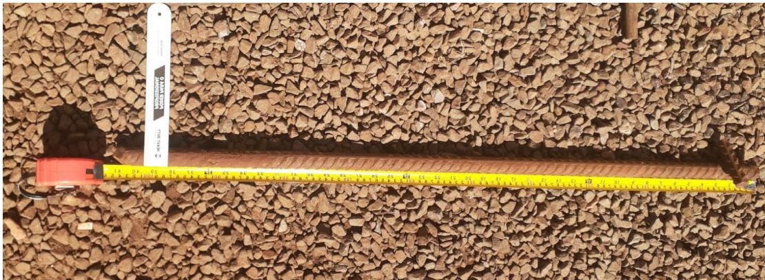
Figura 6 – Estaca de ancoragem sendo medida
