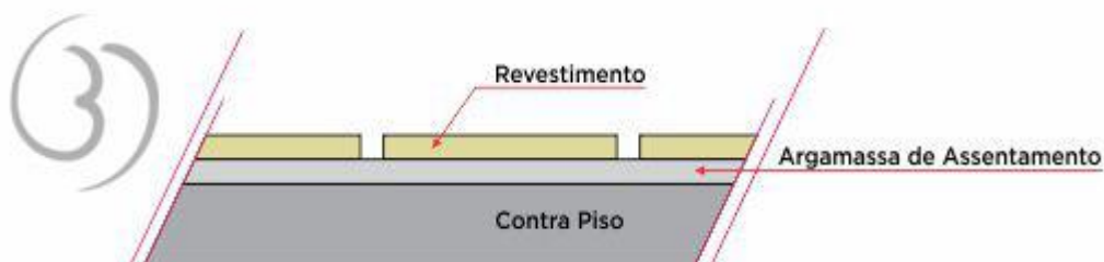
FIGURA 1 – CAMADAS DE EXECUÇÃO: PLACAS CERÂMICAS.
