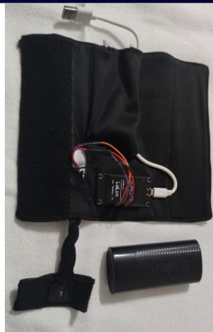
Figura 2: Luva confeccionada para monitoramento cardíaco. Fonte: foto dos autores
