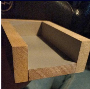
Figura 5: Molde utilizado para fabricação dos corpos de prova Fonte: Autora (2023)
