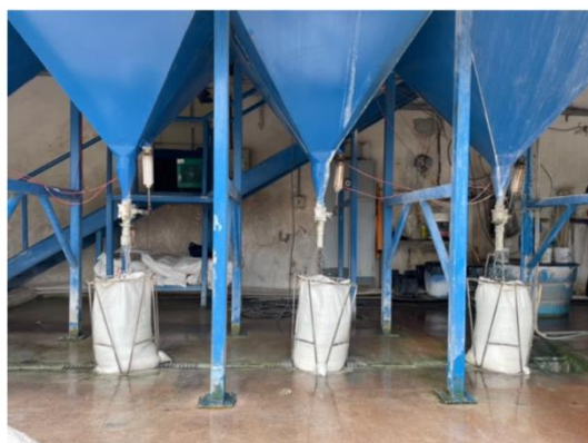
Figura 1: Decantação em funis da mistura de PDV e água na empresa
