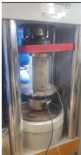
Figura 3: Disposição do ensaio de compressão Fonte: Autores (2023)
