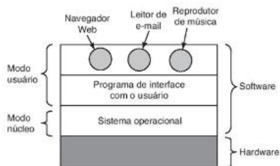
Figura 3 Arquitetura de um Sistema Operacional Fonte: Tanebaum, 2017
