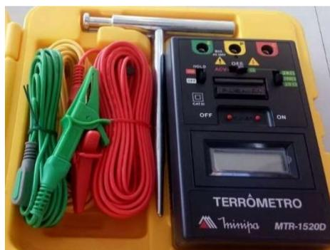
Figura 15: Modelo Digital Terrômetro
