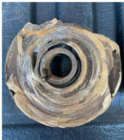
Figura 05: Rotor de bomba centrífuga após sofrer cavitação.
