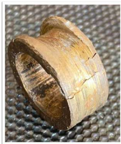
Figura 07: Separador de rotor de bomba centrífuga após sofrer cavitação.
