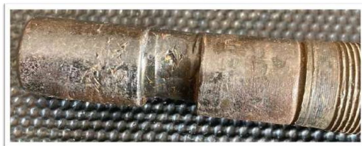
Figura 08: Eixo de bomba centrífuga após sofrer vibrações geradas pela cavitação.
