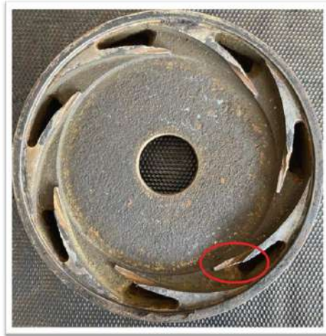
Figura 06: Divisão de estágios de bomba centrífuga após sofrer cavitação.
