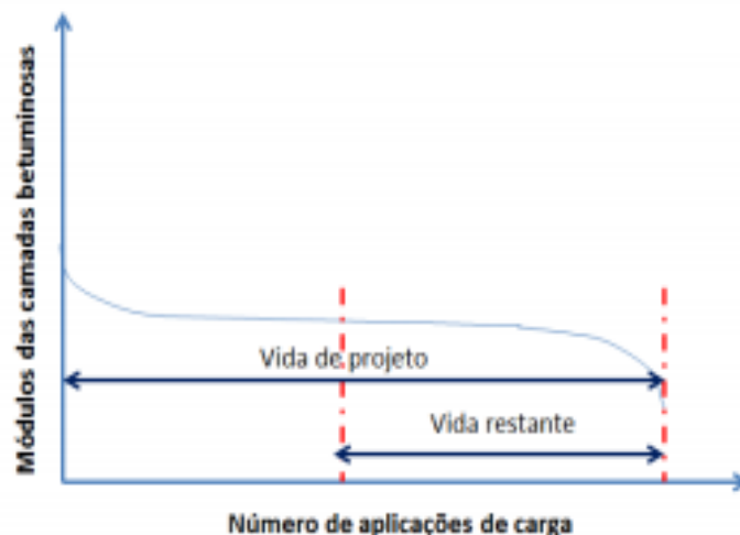
Figura 3: Capacidade de carga de um pavimento (MAIA, 2012, p.52)
